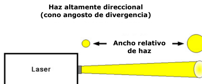
Figura 6. Direccionabilidad del haz Láser y su divergencia
